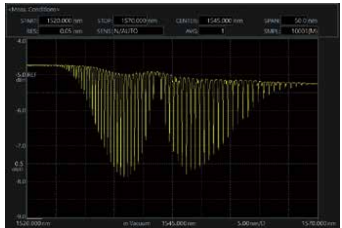
氨化氢 \text{H}_3\text{C}_{14}\text{N} 的吸收光谱测量(AQ6375E)
