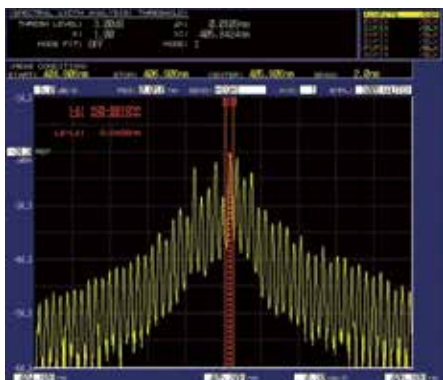
405nm FP-LD测量(分辨率设置: 0.01nm)
